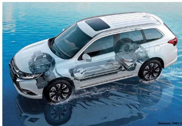
Schemat zasilania samochodu typu PHEV. Źródło: www.mitsubishicars.com
